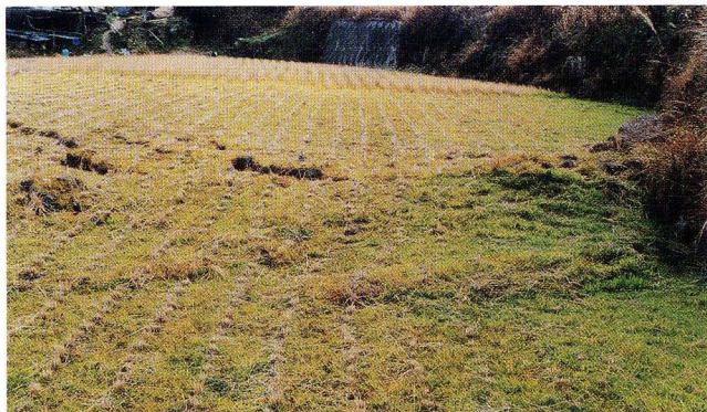
写真12. 地点⑰. 撓曲状の変形
