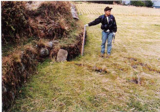
写真 9. 地点⑮. 畦境界の右ずれ変位 Photo. 9 Right-lateral offset of boundary wall of paddy at Loc ⑮
