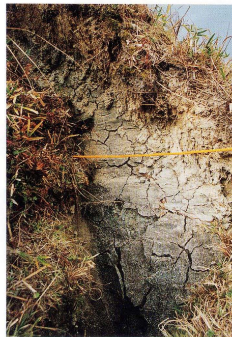
写真42. 地点⑥. 水田におけるモールトラック状変形 Photo. 42 Mole track associated with surface fault in paddy, at Loc ⑥
